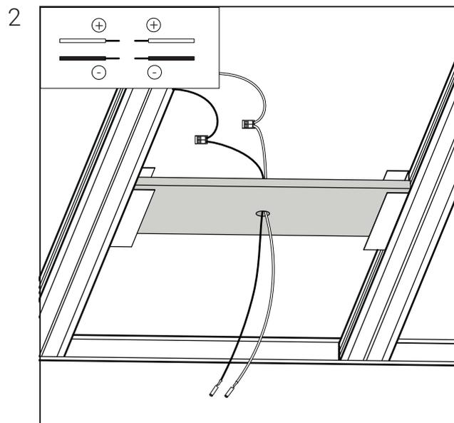
Проденьте провода для подключения (поз. 6) в отверстие и подключите клеммы к кабелю питания.
