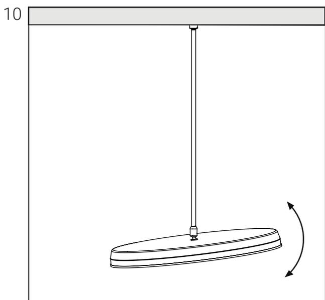
Отрегулируйте наклон светового модуля.
