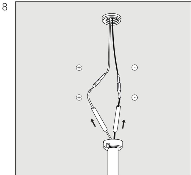
Наденьте термоусадку и соедините клеммы с соблюдением полярности. Надвиньте термоусадку на разъемы, усадите при помощи фена.
