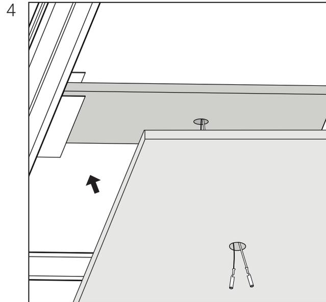
Установите листы гипсокартона, сделав отверстие диаметром 12мм в точке крепления светильника.
