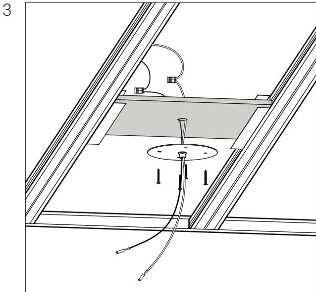
Установите потолочное крепление ( поз. 3) на закладную деталь.
