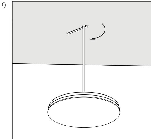
Прикрутите штангу к потолочному креплению до упора. Затем подтяните контр-гайку, используя ключ для сборки (поз. 7).
