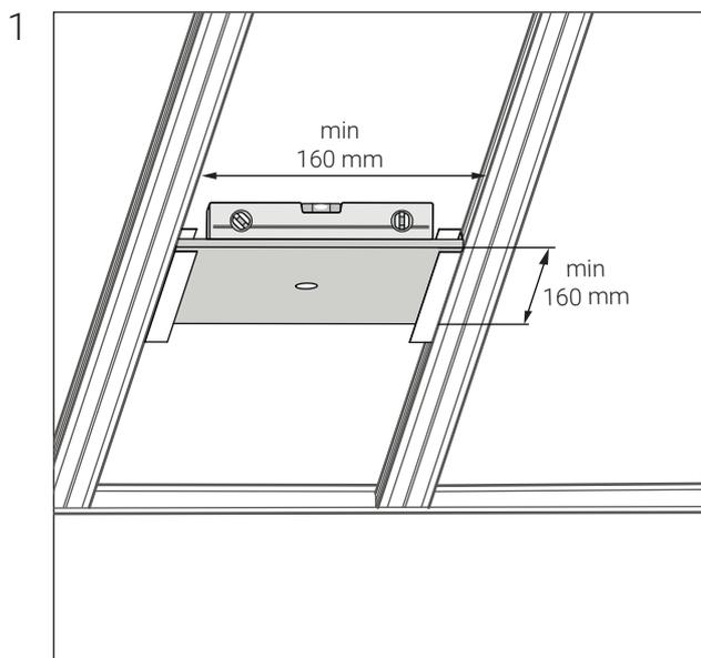
Установите закладную на несущие металлоконструкции по уровню, горизонтально. Просверлите отверстие диаметром 18-20 мм для вывода кабеля. Минимальный размер закладной 160x160мм. В качестве закладной рекомендуется использовать фанеру толщиной не менее 10 мм.
