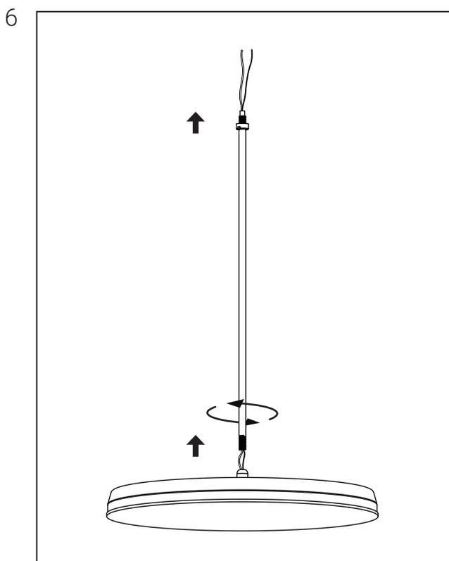
Проденьте кабель светового модуля светильника EVO NO (поз. 2) через штангу (поз.5) так, чтобы стопорная гайка оказалась сверху. Закрепите штангу на светильнике с помощью резьбового соединения.
